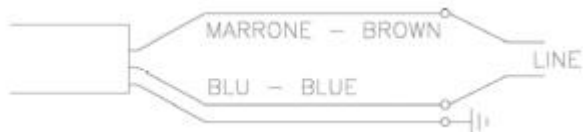
OBR. 1: SCHÉMA ZAPOJENÍ MOTOR ADY 4TW:
