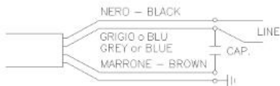
OBR. 1: SCHÉMA ZAPOJENÍ STANDARDNÍHO PROVEDENÍ řady 4GG:
